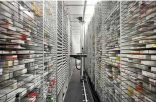
ABB. 1 ▶ Kommissionierroboter in der Krankenhausapotheke des Universitätsklinikums Münster
