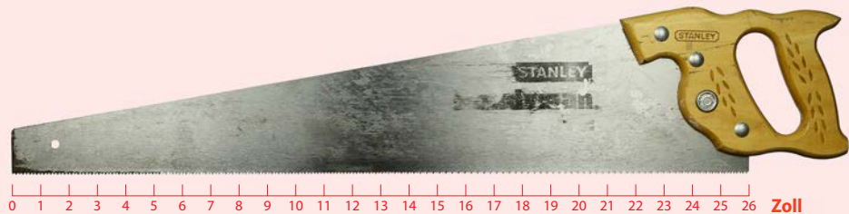
Abb. 1–38 Ein klassischer Fuchsschwanz aus den 1970er-Jahren, als sich Handkreissägen noch nicht am Markt durchgesetzt hatten. Der englische Begriff »Panel Saw« (Formatkreissäge) leitet sich von der Anwendung der Säge ab, mit der große Holztafeln (Panels) gesägt wurden. Das abgebildete Exemplar besitzt 9 Zähne pro Zoll (ZpZ). Es gab aber auch Varianten mit 8 bis 10 ZpZ.
