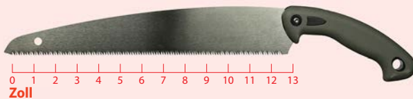
Abb. 1-42 Eine Japansäge (Zugsäge) mit 9 ZpZ
